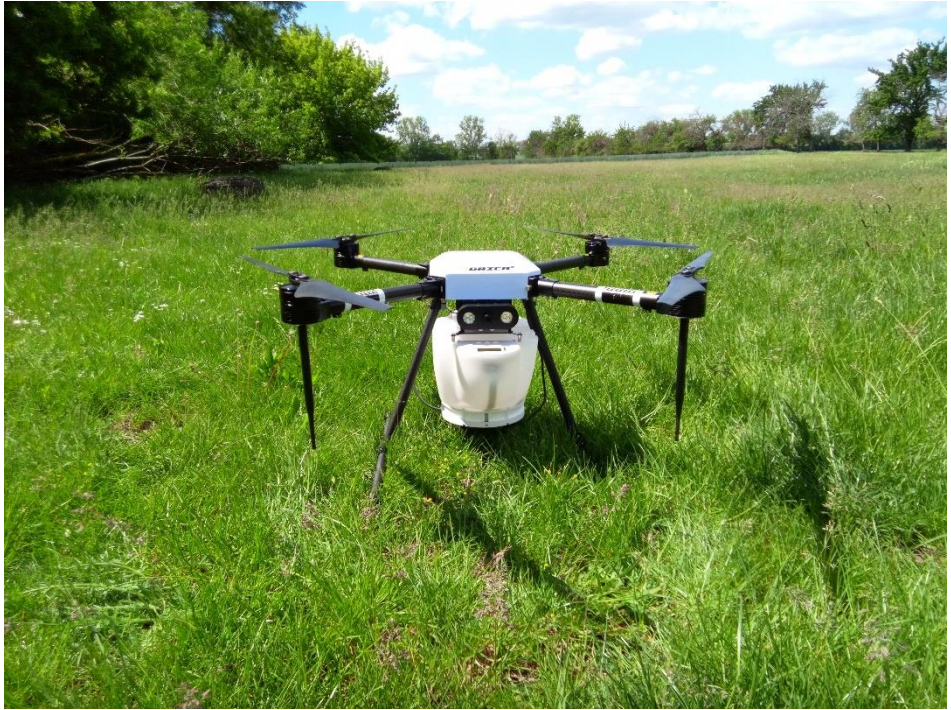
Abbildung 34: Agrica 3 UAV mit Abwurfteinheit für Trichogrammakapseln
