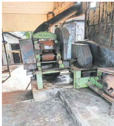
Mit der Zuckerrohrpresse wird „Caldo de Cana“ (Zuckerrohrsafte) gewonnen, der dann mit Wasser verdünnt und mit Hefe versetzt ungefähr 24 Stunden gären muss, bevor er destilliert werden kann.
