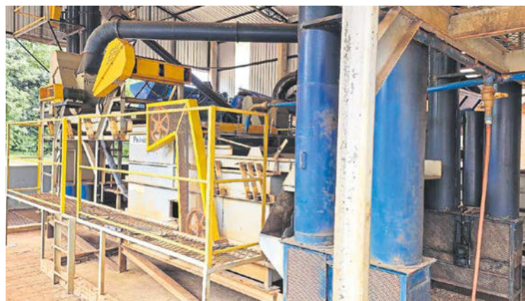
In der Aufbereitungsanlage werden die Früchte sortiert, wenn bei der Ernte reife, unreife und überreife Kirschen nicht unterschieden werden.
