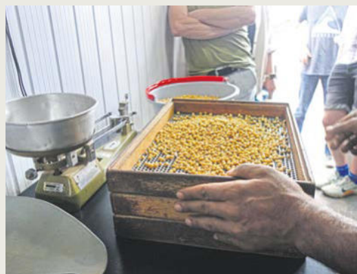
Bei der Annahme werden die Sojabohnen beprobt und nach Reinheit, Feuchte und Bruch bewertet.
