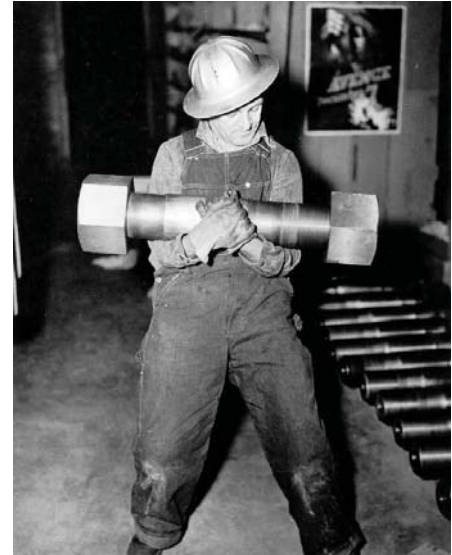
Abbildung 4.6: M100-Schraube, Gewicht inkl. Mutter ca. 42 kg
