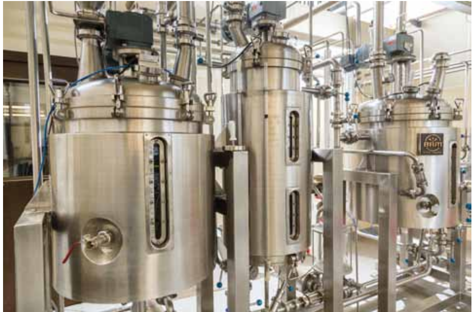
Abb. 2 3-Geräte-Sudwerk der Forschungs- und Lehrbrauerei der Hochschule Anhalt in Köthen
