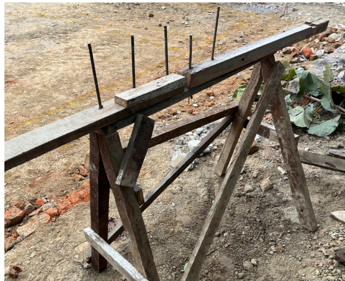
Biegetisch für die Bewehrung Abbildung Bindl Raphael
