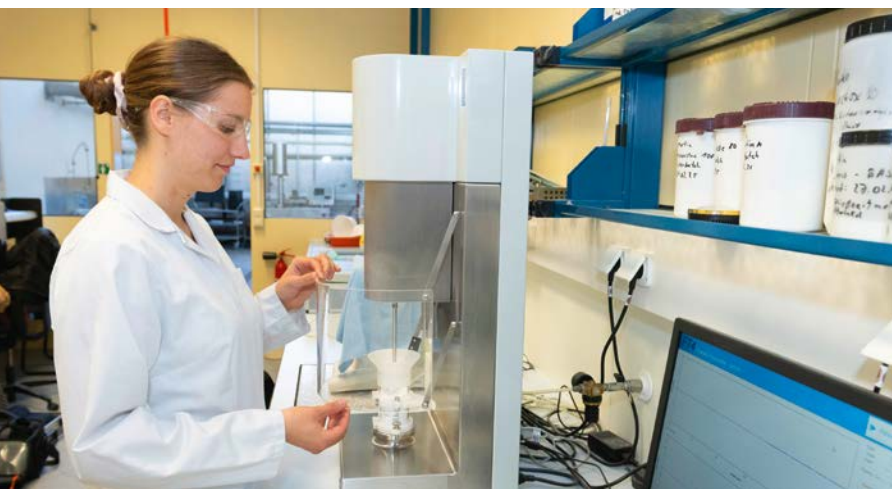
Messungen im Labor mit dem Pulverrheometer von Freeman Foto: Uwe Jacobshagen
